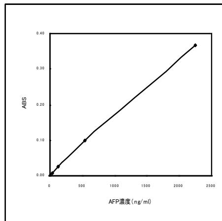
高濃度に AFP を含む検体ではプロゾーンチェック機能が作動し、測定結果に表示されます（注：日本電子 BM2250・BM1650 でのパラメーターを用意してあります）。
